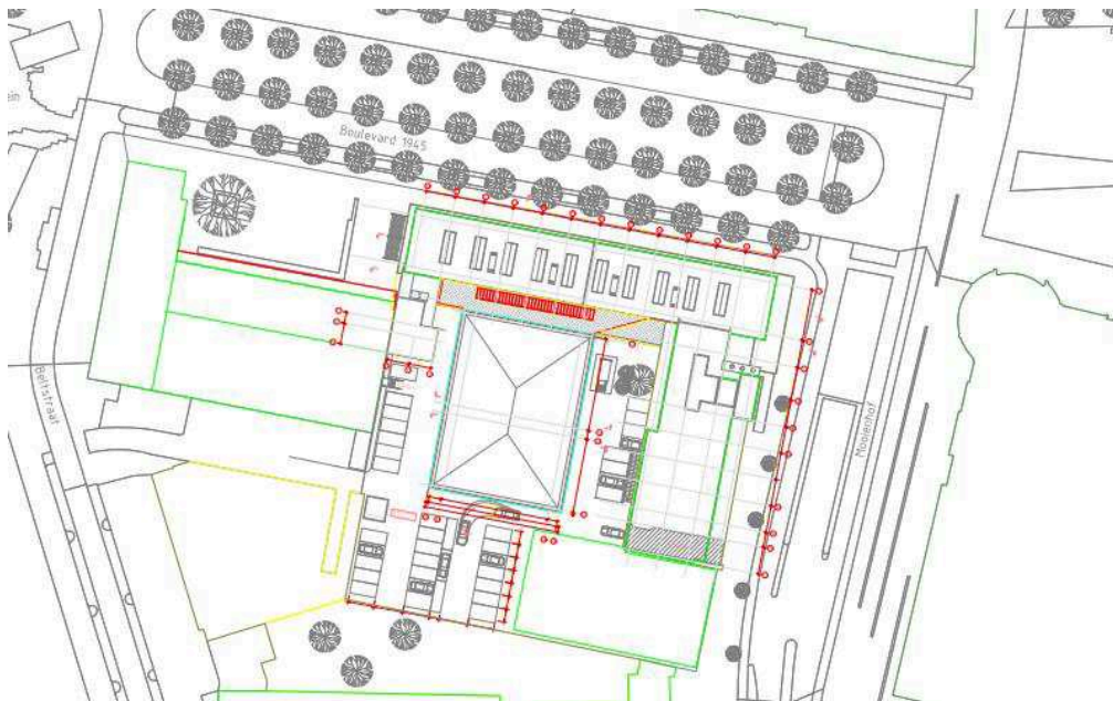
Afbeelding 4.6: Tekening van het nieuwe plattegrond van het gebouw met de uitbreiding daarop aangegeven (met een blauwgroene omlijning, met een kapconstructie).
