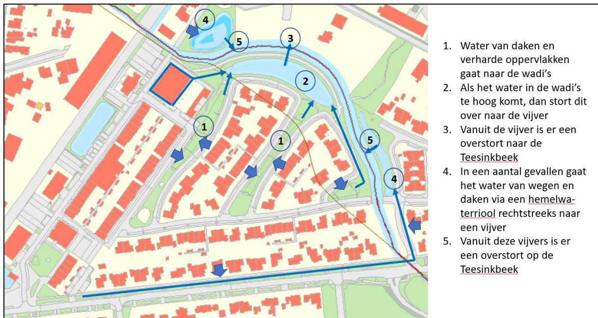
Figuur 8: Schematische weergave van watersysteem in de wijk
